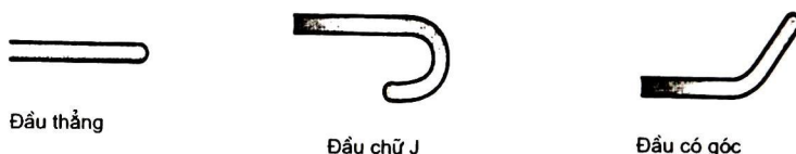
Hình 8.8: Các loại đầu của dây dẫn đường
