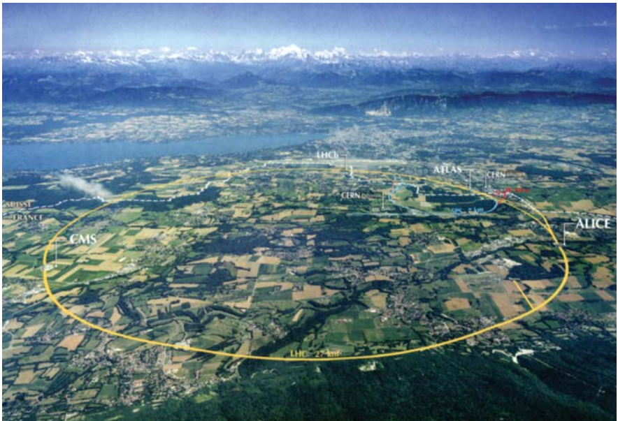
19. LHC (Large Hadron Collider) là máy gia tốc hạt mạnh nhất thế giới. Nó được đặt trong một đường hầm tròn có chu vi dài 27km, ở độ sâu trung bình 100m dưới biên giới Pháp-Thụy Sĩ gần Geneva.
