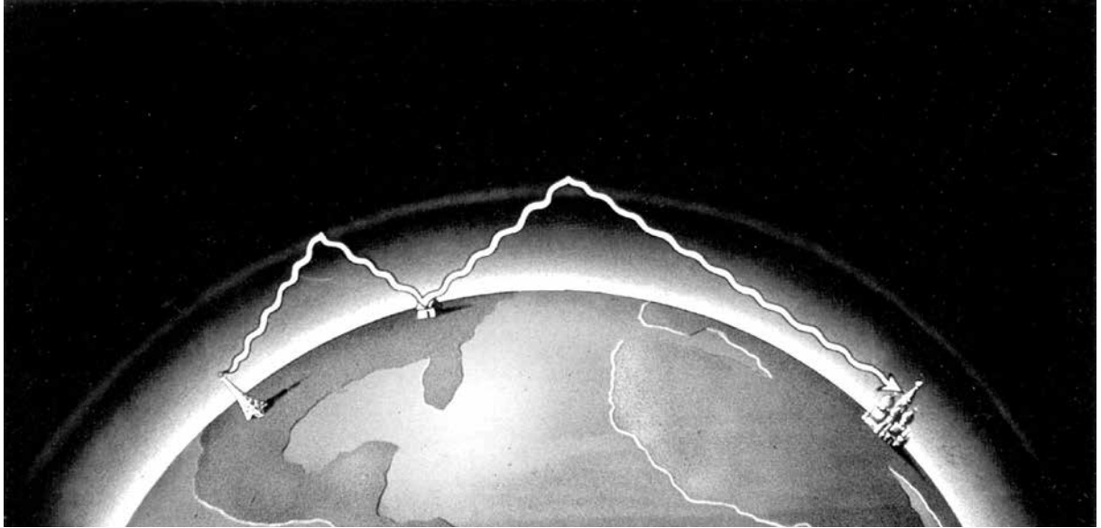
Tầng điện ly phản xạ sóng vô tuyến và cho phép thực hiện liên lạc vô tuyến giữa các nước và các lục địa
