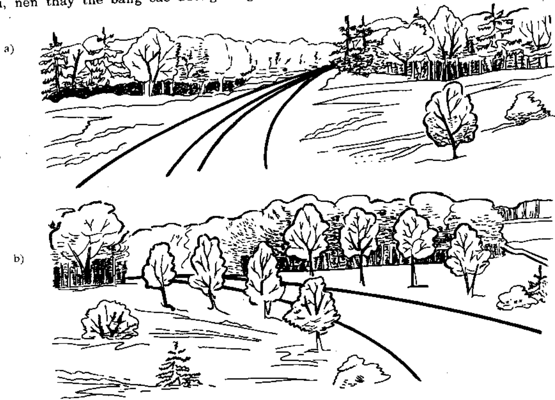
Hình 6-5. Đường đi qua rừng a - bố trí đường cong bán kính lớn ở cửa vào ; b - trồng thêm cây ở cửa vào.
